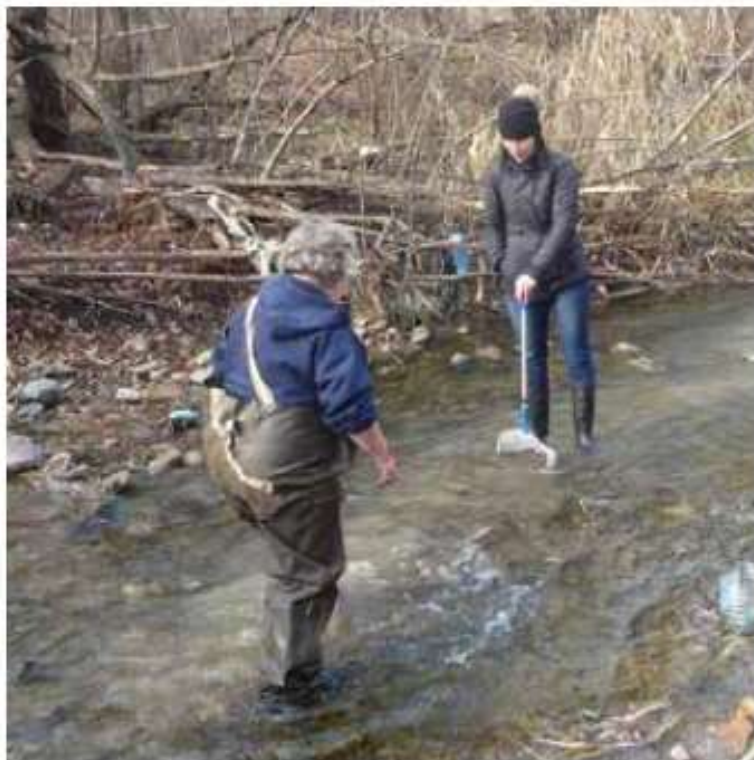
Рис. 1. Отбор проб методом принудительного дрифта с помощью донного сачка (А); донный сачок (Б)
